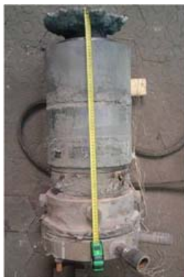
Рис. 11.11. Изношенный подовый электрод фирмы «РОУД»
