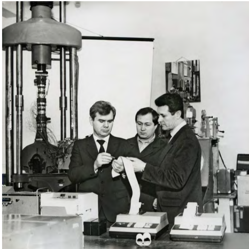
1970 р. «Лаборатория прочности». Випробування шахтних гідравлічних стоек
