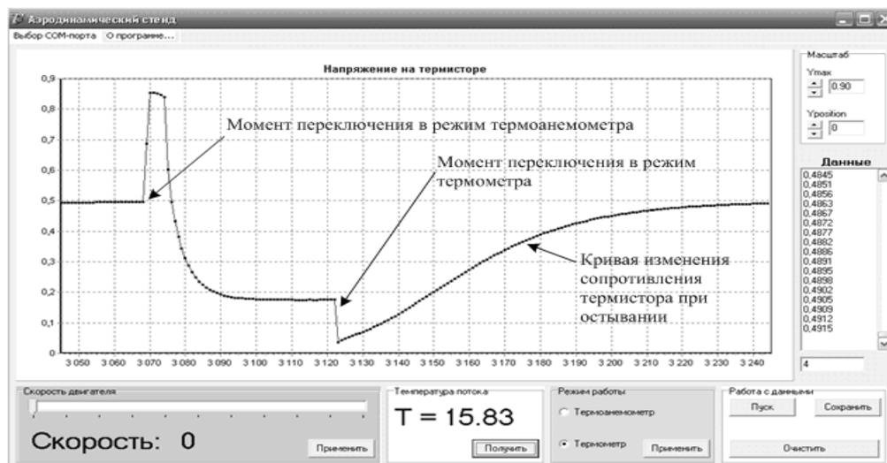
Рис. 7. Окно программы управления режимами и регистрации измерительных данных малого аэродинамического стенда
