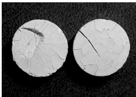
Рис. 1. Деградация керамики на основе диоксида циркония в гидротермальных условиях при T=250^\circ\text{C}
