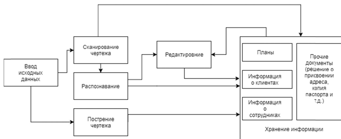
Рис. 1. Схема работы автоматизированных комплексов, используемых при работе БТИ
