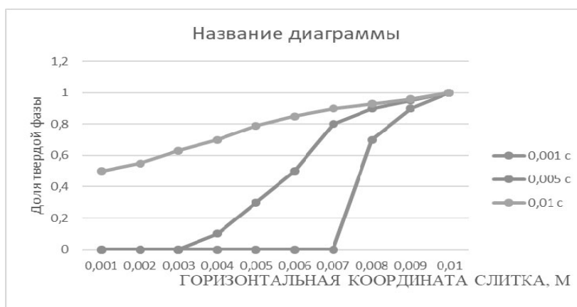
Рис. 3. Распределение доли твердой фазы слитке в различные моменты времени
