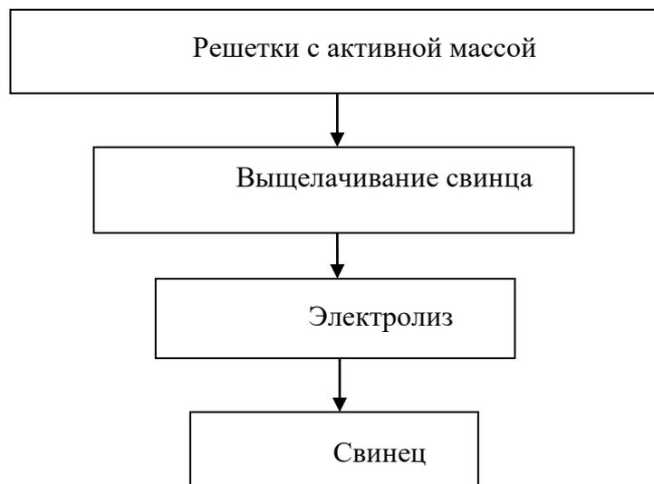
Рис. 2. Схема проведения процесса переработки свинцово-кислотных аккумуляторов
