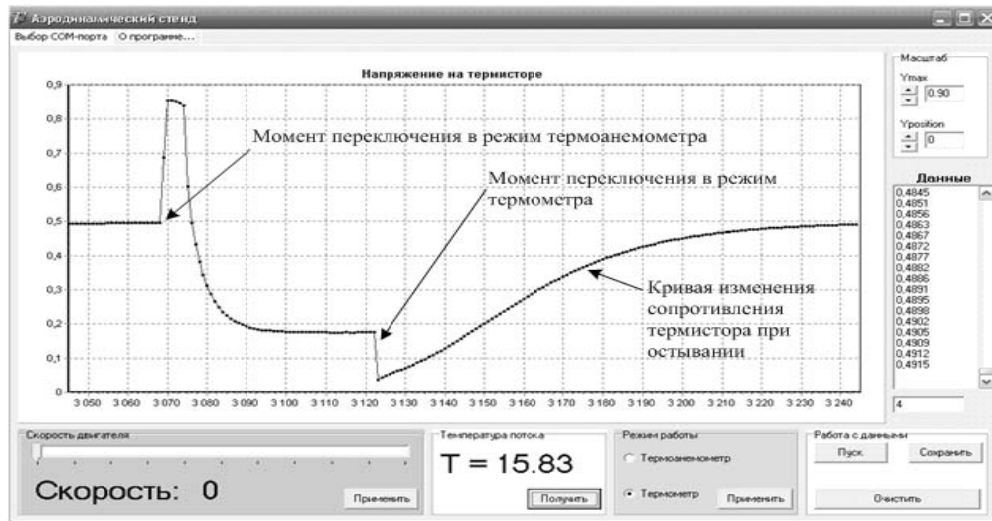
Рис. 2. Окно программы управления режимами и регистрации измерительных данных малого аэродинамического стенда
