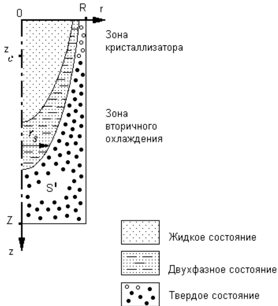
Рис. 1.2. Схема непрерывного цилиндрического слитка
