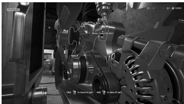
Рис. 1 Обозначение контуром и названием водяного насоса системы охлаждения двигателя
