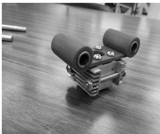
Рис. 4. Лазер прожига в сборе с кареткой
