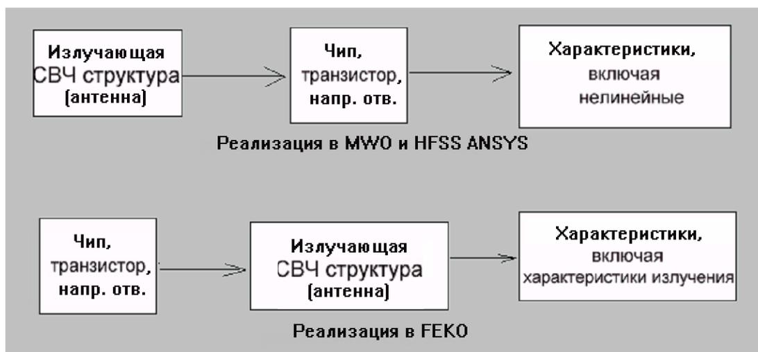
Рис. 2. Два метода объединения неизлучающих цепей (чипы, транзисторы, дискретные направленные ответвители) и излучающей электродинамической структуры
