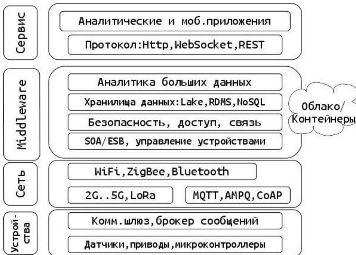
Рис. 1. Архитектура облачной платформы IoT
