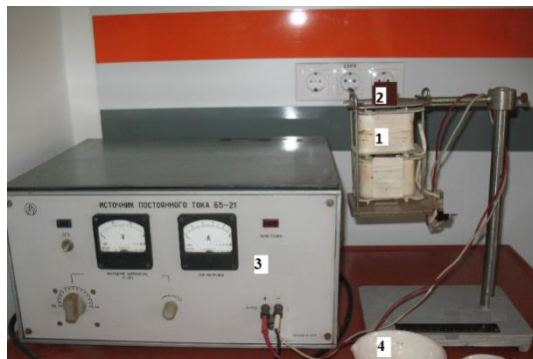
Рис. 2. Установка для определения магнитно-массовой пробы магнитно-абразивных порошков
