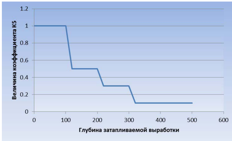
Рис. 2. – Визуализация графика изменения коэффициента K_5 с увеличением глубины согласно действующему нормативному документу.
