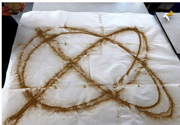
Рис.1 - Фигура Лиссажу, созданная при помощи колеблющейся воронки с песком
