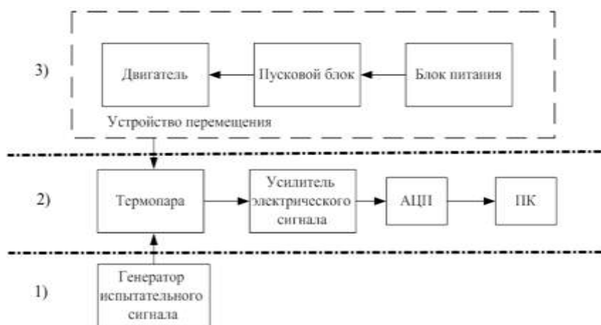
Рис. 6. – Блок – схема измерительного стенда для исследования динамических характеристик термопар.
