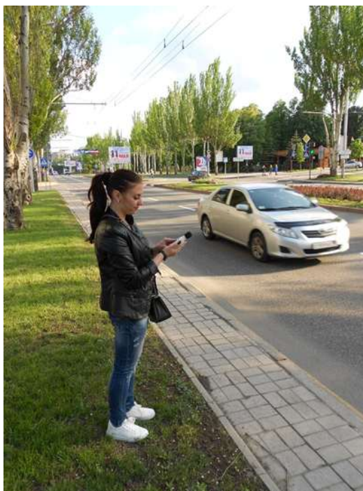
Рисунок 2 – Методика измерения шума возле автодороги с помощью шумометра Benetech GM1351
