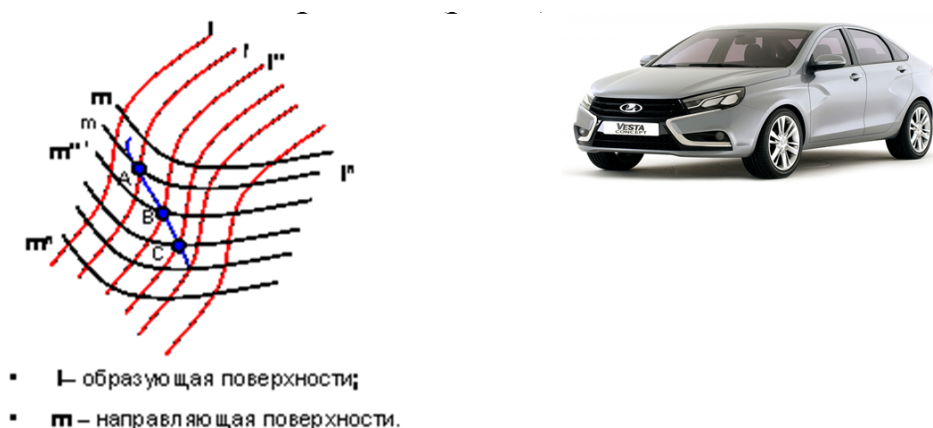
Рис. 1. Пример реализации графических преобразований при конструировании поверхностей в автомобильном машиностроении
