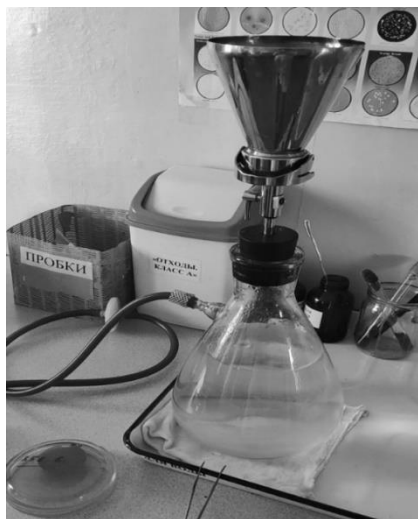
Рис. 1. Установка для фильтрации воды
